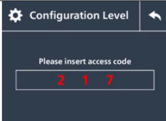
Schalten Sie das Gerät bei gedrücktem Drehknopf ein, bis die Anzeige „Coniguration Level“ erscheint. Geben Sie den Zugangscode „217“ ein.
