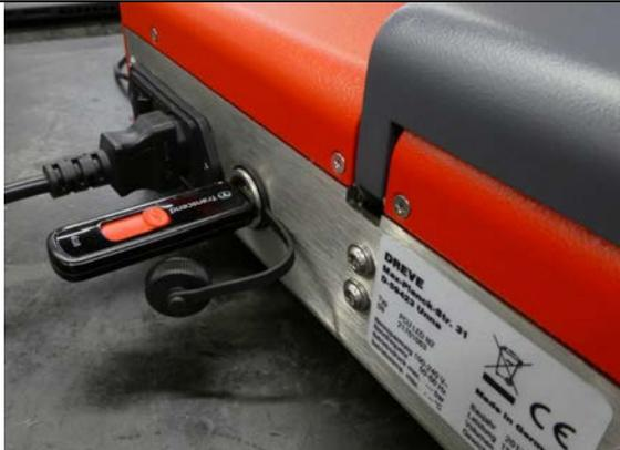
Verbinden Sie den USB-Stick mit der PCU-LED. Importieren Sie die Datei, indem Sie unter "Data Exchange" auf der PCU-LED "Config Import" wählen. Die Materialparameter sind nun in der Materialbibliothek zu finden.
